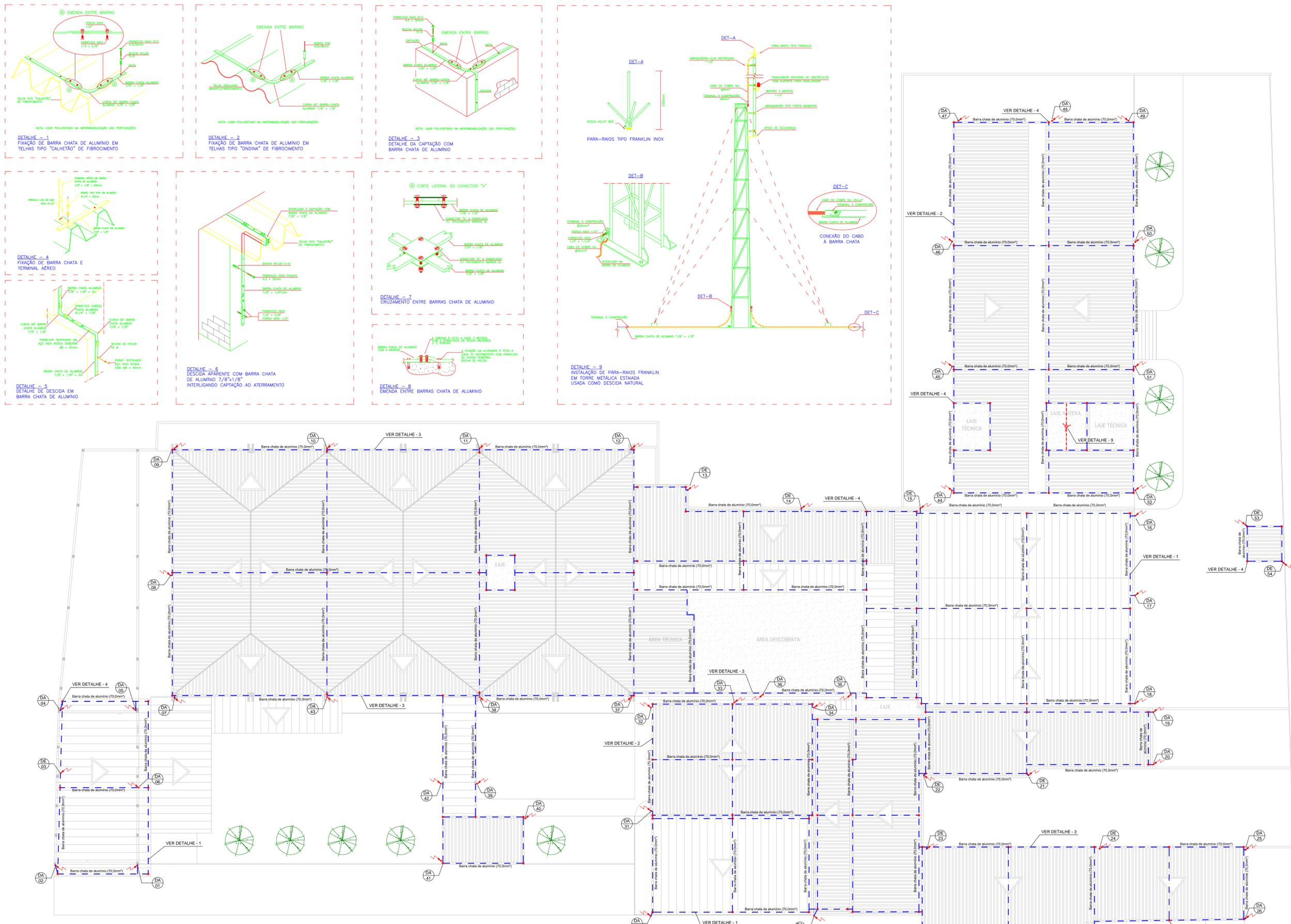
PLANTA DE COBERTURA - DISTRIBUIÇÃO DA MALHA E TERMINAL AÉREO
