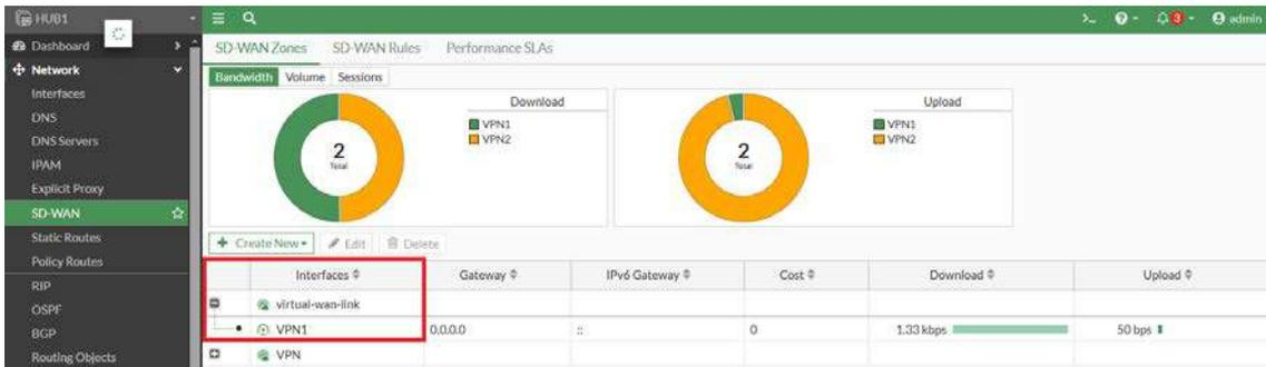
Note o “Performance SLA” tendo como integrante apenas a interface lógica “VPN1”. É nítido conforme imagem anterior e esta, que apenas a interface “virtual-wan-link” com apenas um link ora o “VPN1”, permitindo ver em tempo real a monitoração do link com tempo de resposta por fator de monitoração e saúde (Packet Loss, Latency e Jitter).
